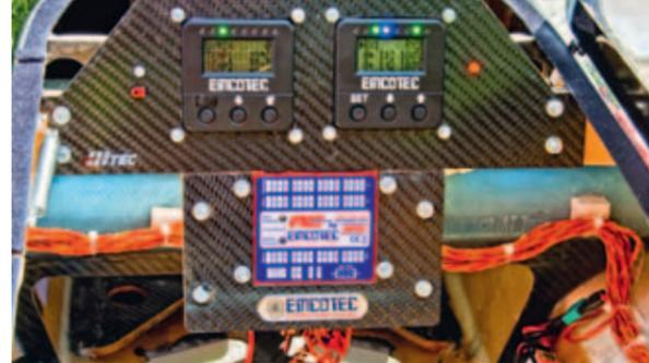
Von links: Kontroll-LED des Zündschalters (Bestandteil des Emcotec TSC), darunter der Programmierstecker des Emcotec TSC, LC-Display des Emcotec DPSI und die Kontroll LED des verdeckt eingebauten Emcotec Magnetschalters. Darunter befindet sich das Emcotec DPSI Twin Mini Pro Bluetooth
