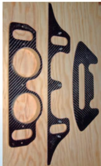
Die selbst erstellten Spanten für die Tanklagerung
