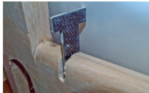
Die Scharniere für die Lagerung des Seitenruders sind aus 3-Millimeter-Sperholz nebst CFK-Beschichtung selbst hergestellt worden. Das „T“ liegt innen, hinter der Abschlussleiste des Rumpfs
