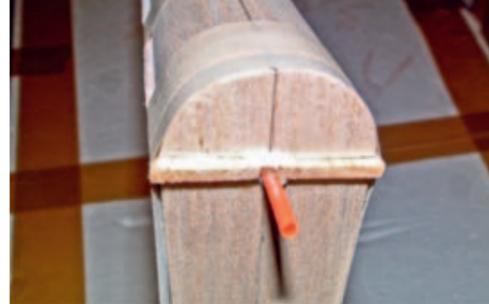
Für die Lagerung des Seitenruders in der Hohlkehle wurde die Nasenleiste aufgesägt und ein Rohr eingeklebt, in dem später der Stahlstift für die Arretierung sitzt
