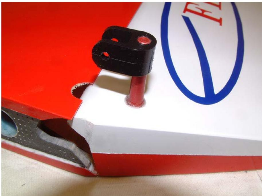
Die Ruderhörner können auf die von ihnen gewünschte Länge abgetrennt werden bevor Sie diese einkleben. Als bestes hat sich herausgestellt, die Ruderhörner so zu kürzen, dass der Kugelkopfanschluss auf gleicher Höhe mit dem Servohebel ist.
