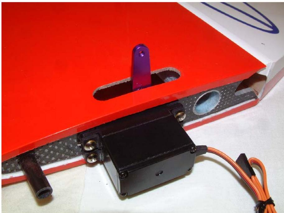
Öffnen Sie nun mit einem scharfen Messer die Löcher für die Ruderhörner. Unter den angegebenen Löchern sind bereits fertige Führungen für die Ruderhörner eingelassen. Schleifen Sie die Aluminiumruderhörner gut an und kleben Sie diese mit Harz in die Löcher ein.
