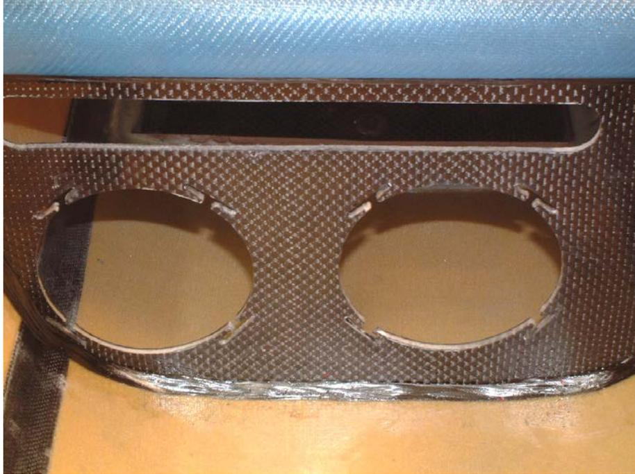
Die eigentliche Lagerung der Dämpfer, übernehmen jetzt 8 Silikonschlauchstücke, die Sie aus Silikonschlauch mit einem Außendurchmesser von 12mm und einer Länge von 20mm, erstellen. Stecken Sie den Schlauch in die Schlitzte und lassen Sie die Dämpfer einmal „Probesitzen“.
