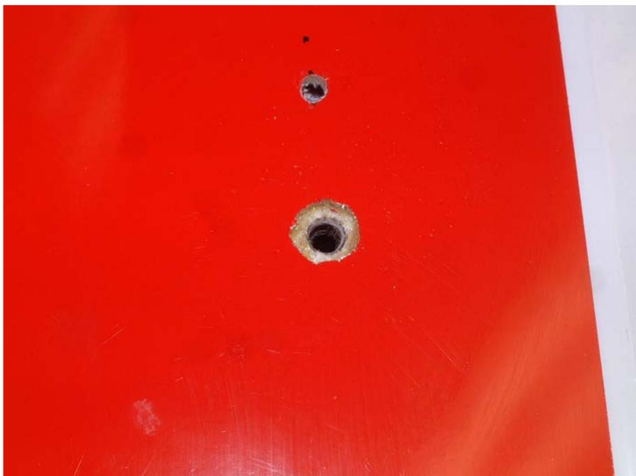
Sobald das Loch gebohrt ist, schneiden Sie ein M4 Gewinde komplett durch Leitwerk und Steckrohr. Ziehen Sie dafür nicht das Rohr aus dem Leitwerk! Entfernen Sie, wie auf dem oberen bild zusehen, das Laminat um dem Loch, so dass Sie Ihre M4 X 16 Senkkopfschraube darin versenken können.
