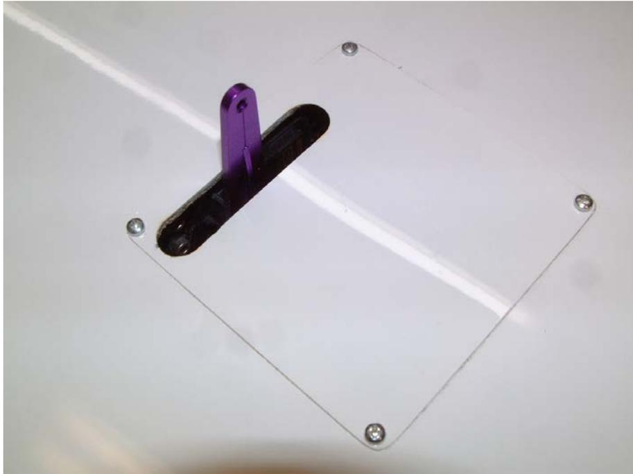
Öffnen Sie jetzt wieder die Löcher für die Ruderhörner mit einem 6mm Bohrer oder einem scharfen Messer. Längen Sie die Ruderhörner auf das von Ihnen gewünschte Maß ab und Harzen Sie diese in die Löcher ein. Unser Beispiel hat eine Länge von 20mm von Fläche bis Mitte Bohrung für den Kugelkopf.
