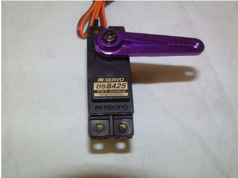
Setzen Sie jetzt die Servos in das Leitwerk ein und schrauben Sie diese an. Die Servos werden hierbei Kopfüber in das Leitwerk geschraubt.
