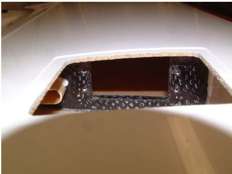
Die Servos werden jetzt mit jeweils 4 M 2,5 X 14 Schrauben samt Unterlegscheibe in die Flächen geschraubt. Damit Sie später keine Schraube im Flug verlieren können, sollten Sie die Schrauben mit einem kleinen Tropfen blauem Loctite sichern!
