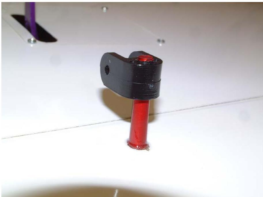
Fertigen Sie sich nun die Schubstangen zwischen Servo und Ruderhorn an. Diese bestehen hier im Bild aus einer 3mm Edelstahl Gewindestange die mit etwas Schrumpfschlauch überzogen wurde. Der Schrumpfschlauch dient hier lediglich der Optik.
