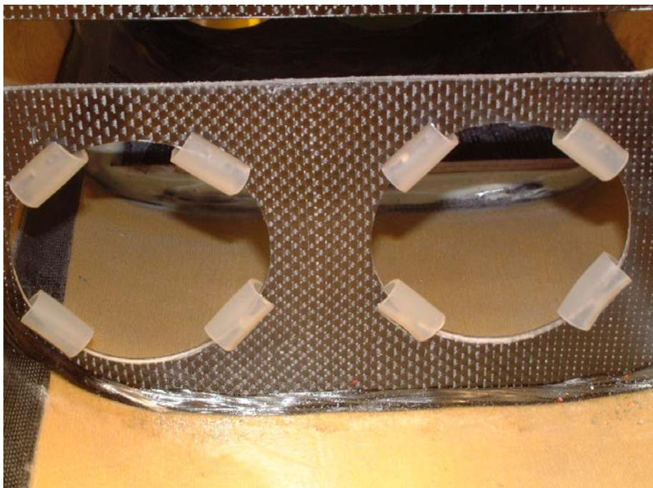
Jetzt geht es daran, die Tankhalterungen fertig zu stellen. Diese Halterungen sind speziell passend für 0,5L Coca-Cola PET Flaschen gefräst. Sie können die Halterungen erst jetzt in die Grundplatte einkleben, da Sie ansonsten die Grundplatte nicht mehr in den Rumpf bekommen hätten wenn Sie diese außerhalb des Rumpfes komplettiert hätten. Das erste Bild zeigt wie es später im Rumpf aussehen sollte. Auf dem zweiten sehen Sie die fertigen Tankhalter im Rumpf eingearzt.
