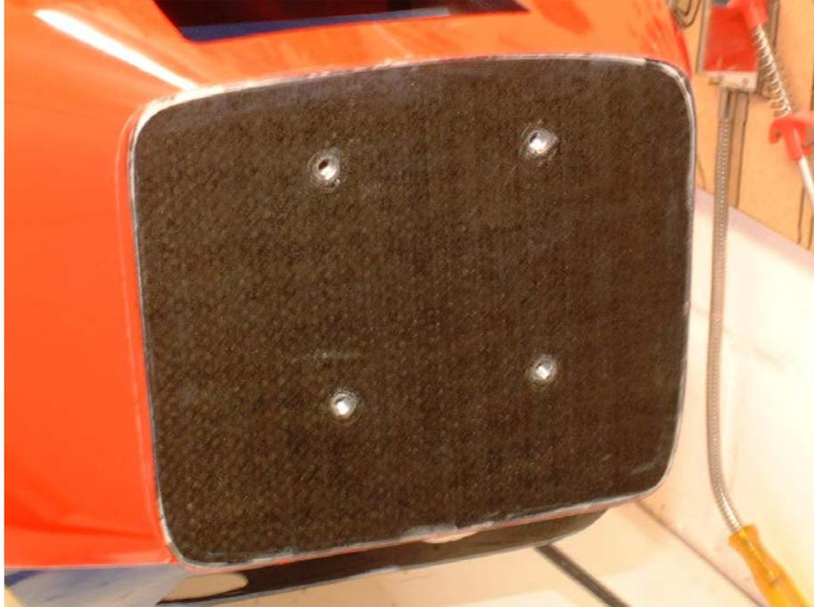
Jetzt können Sie den Motor passend zur Motorhaube ausrichten. Wenn alles sitzt, zeichnen Sie die Befestigungslöcher an und bohren Sie diese in den Motorspant. Anschließend treiben Sie vier M6 Einschlagmuttern, von Innen, in den Motorspant. Befestigen Sie probeweise Ihren Motor und überprüfen Sie noch einmal den korrekten Sitz von Motorhaube und Spinnerrückplatte.
