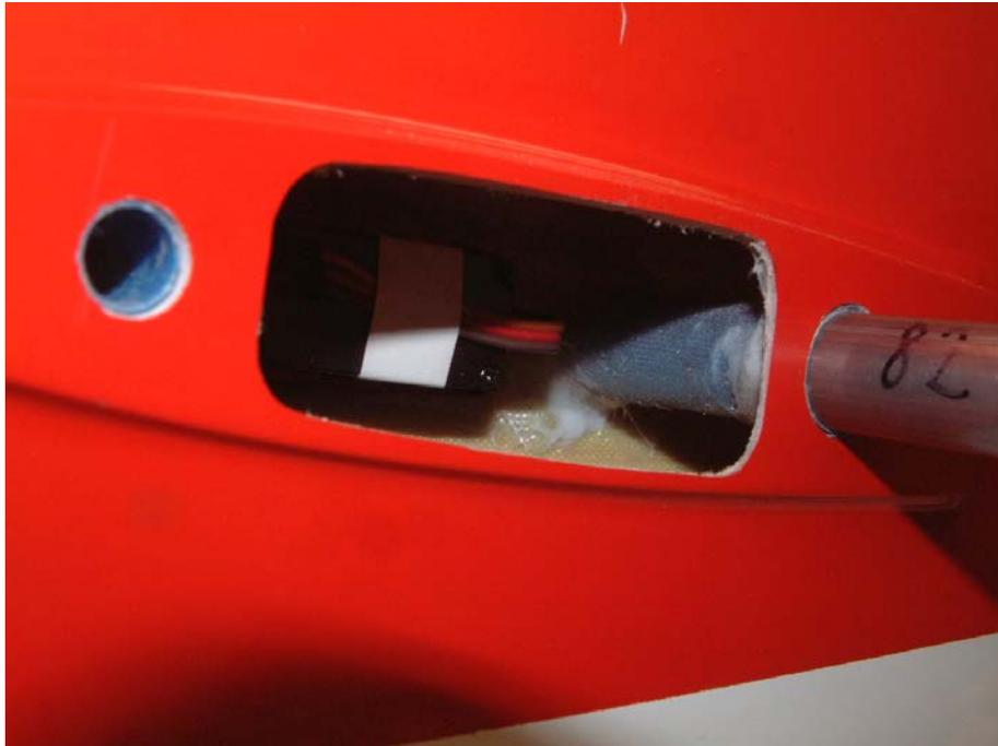
Für die Verschraubung der beiden Leitwerkshälften mit dem Steckungsrohr, sind in den beiden Leitwerkshälften kleine Speerholzplättchen eingelassen. Diese sind durch die Servoöffnung einer jeden Leitwerkshälfte gut zu erkennen. Ermitteln Sie das Maß an der die Plättchen liegen und zeichnen Sie es von Außen auf Ihrem Leitwerk an. Stecken Sie die Steckung in eine Leitwerkshälfte und bohren Sie nun ein 3mm Loch mittig durch Speerholz und Steckungsrohr.
